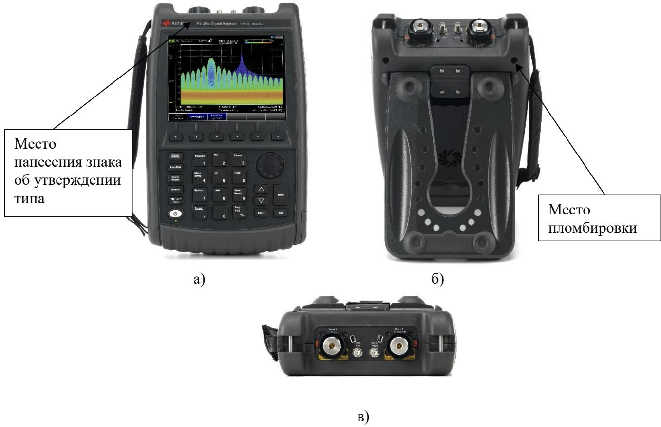
Рисунок 1 - Анализаторы FieldFox N9950B, FieldFox N9951B, FieldFox N9952B, FieldFox N9960B, FieldFox N9961B, FieldFox N9962B
