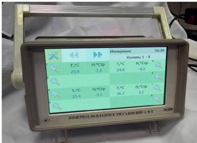
Рисунок 11 - Общий вид модификации ИВГ-1 /X, исполнение ИВГ-1 /8-T
