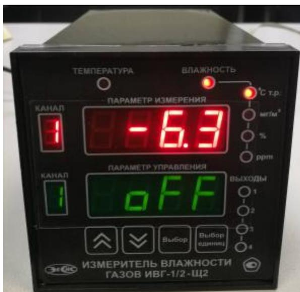
Рисунок 9 - Общий вид модификация ИВГ-1 /Х, исполнение ИВГ-1 /2-Щ2
