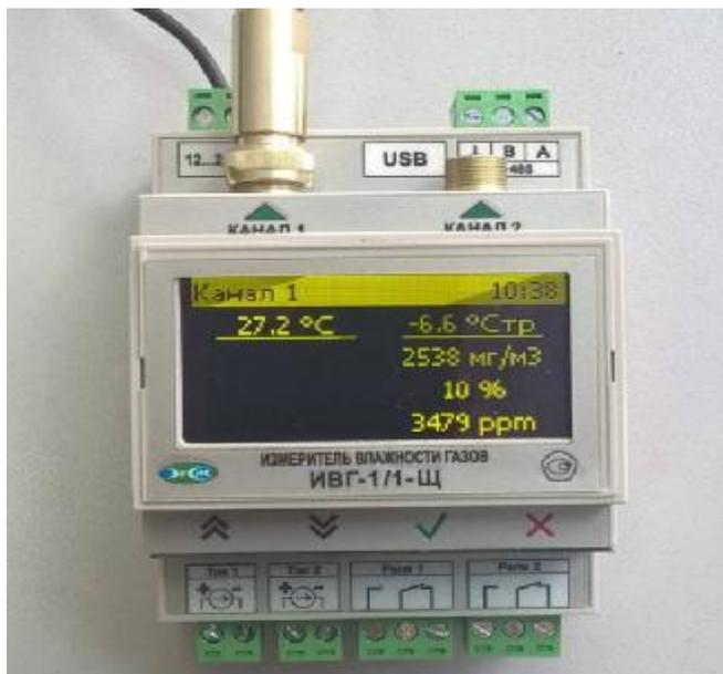
Рисунок 8 - Общий вид модификации ИВГ-1 /Х, исполнение ИВГ-1 /1-Щ-Д
