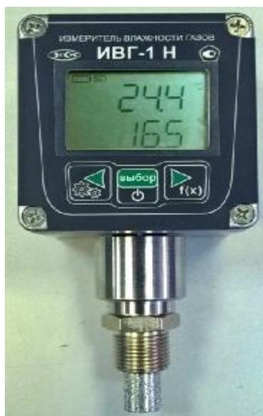
Рисунок 3 - Общий вид модификации ИВГ-1 Н, исполнение ИВГ-1 Н-И-Д1-М20х1,5
