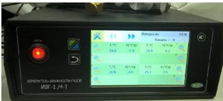
Рисунок 12 - Общий вид модификации ИВГ-1 /X, исполнение ИВГ-1 /4-T
