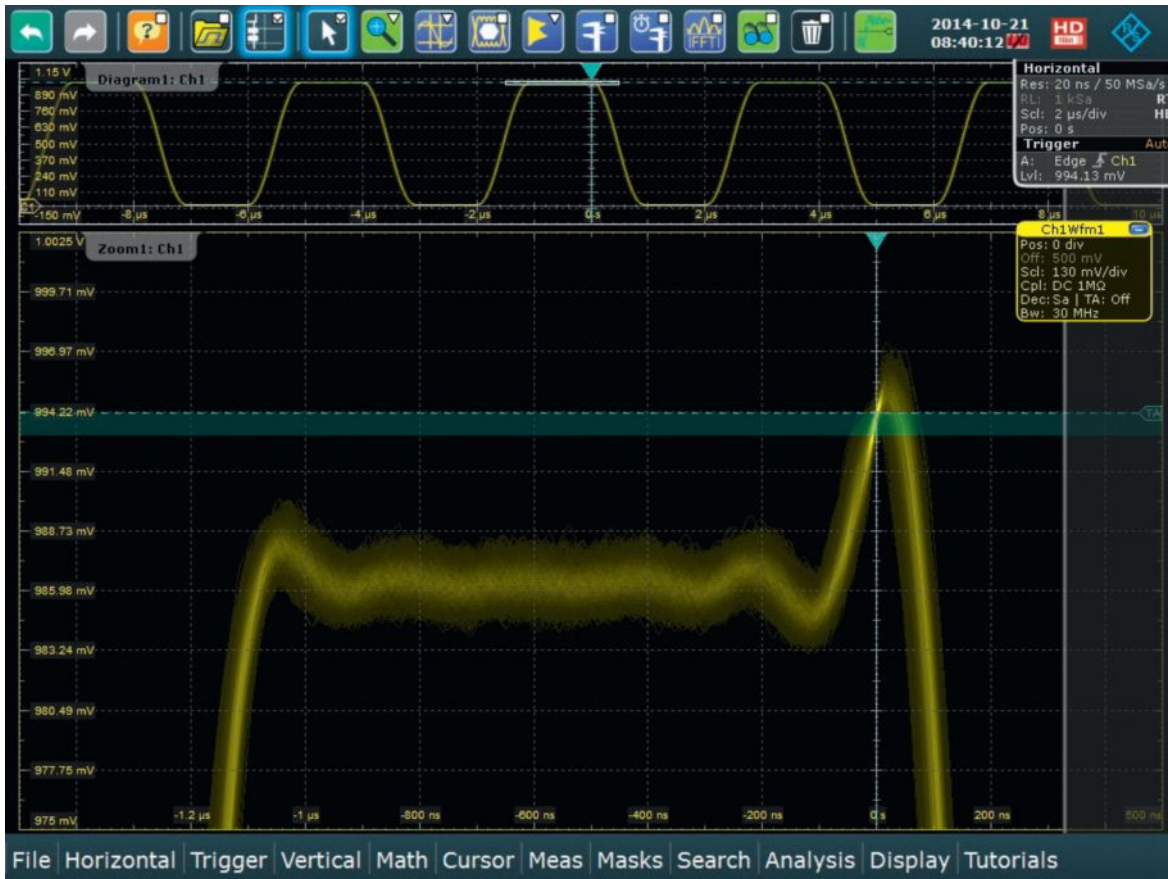
Рисунок 5 – Высокая чувствительность цифрового запуска в этом примере обеспечивает возможность запуска по выбросам сигнала менее 9 мВ. При чувствительности по вертикали 140 мВ/дел это соответствует лишь малой части одного деления отображения.
